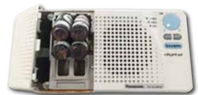
乾電池が液漏れした戸別受信機
