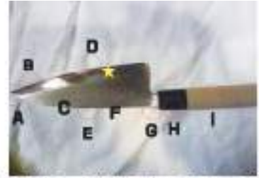
A: 切っ先 | B: そり | C: しのぎ | D: 刃先 | E: 峰 | F: 平 | G: マチ | H: 口金 | I: 柄
