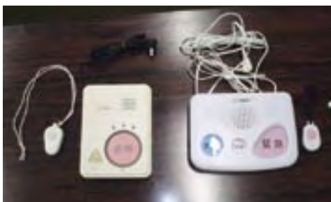
緊急通報装置
