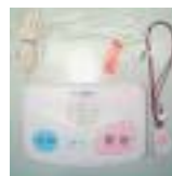
緊急通報システム
