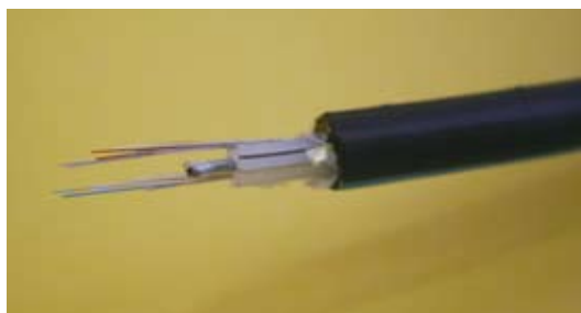
↑雲仙市情報ハイウェイの基幹線となる「光ファイバ」です。光信号での通信を行い、大容量データの送信が可能です。
