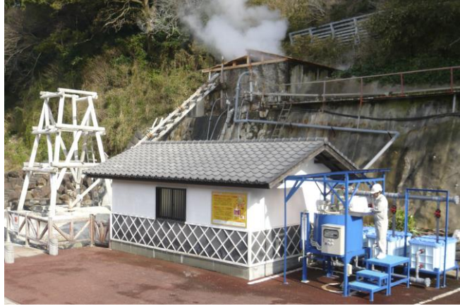
廃食油を活用したバイオディーゼル燃料製造装置
